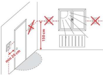
Les appareils doivent être installés dans un endroit intérieur propre et sec, sans flux d'air direct provenant d'un appareil de chauffage ou de refroidissement, et ne doivent pas être exposés à des gouttes ou à des éclaboussures.
