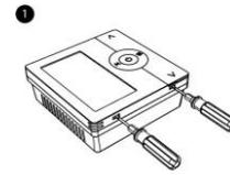
Retirez le couvercle avant en faisant levier avec un tournevis plat au bas du panneau avant.
