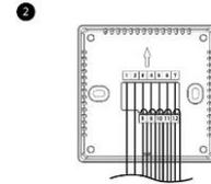
Pour faciliter l'installation, la première étape consiste à câbler les fils sans tension, les fils à basse tension puis les fils à haute tension. Vérifiez que les fils sont bien connectés.
