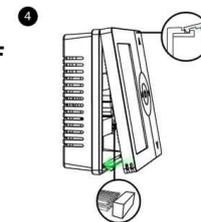
Placez la partie avant du boîtier sur le bord supérieur et assurez-vous que les goupilles sont bien positionnées. Poussez l'avant du boîtier jusqu'à ce que vous entendiez un clic positif.
